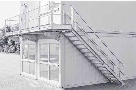
Außentreppe und Podest Direkter Zugang zur zweiten Ebene
